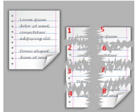
Die Aufgabe von TCP ist es, das Datenpaket, welches zugrunde liegt zu nehmen und in viele einzelne Teile zu splitten. Jedes dieser Teile wird nummeriert.
