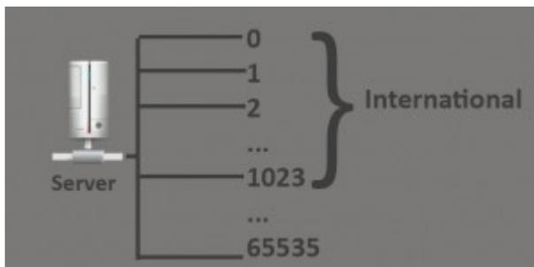
Vergleichbar mit einer Strasse mit 65536 Häusern. Jedes dieser Ports kann eine Aufgabe übernehmen. Berühmte standardisierte Ports sind z.B. Port 80 für das WWW / HTTP, Port 21 für FTP. Dabei sind die Ports von 0 – 1023 standardisiert für Internationale Zwecke bestimmt wie z.B. die eben genannten.
